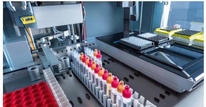
Pipettier-Roboter für Blut-, Urin- und Liquorproben in der Essener Biobank.
